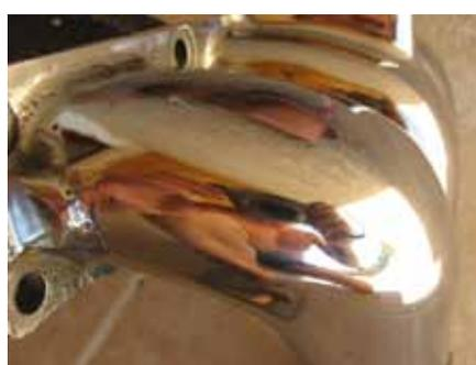
Cependant, il fallait quand même parfaire ce polissage avec du Belgom Alu à l'aide de la roue à polir, puis avec du Belgom Chromes au coton. Pour les parties difficilement accessibles, il existe dans le kit de lustrage Dremel des petites rondelles de feutrine à monter sur le flexible d'une mini perceuse. A l'aide du Belgom Alu, on parvient à un bon résultat.
